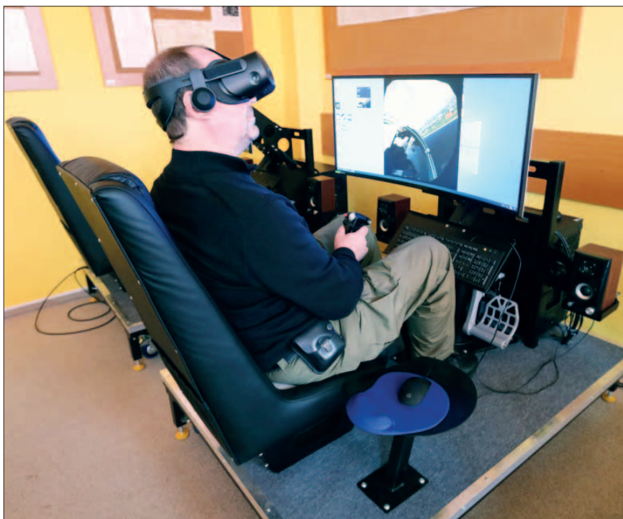
Simulátory s brýlemi pro virtuální realitu slouží například k získání návyků pro skupinovou slétanost
