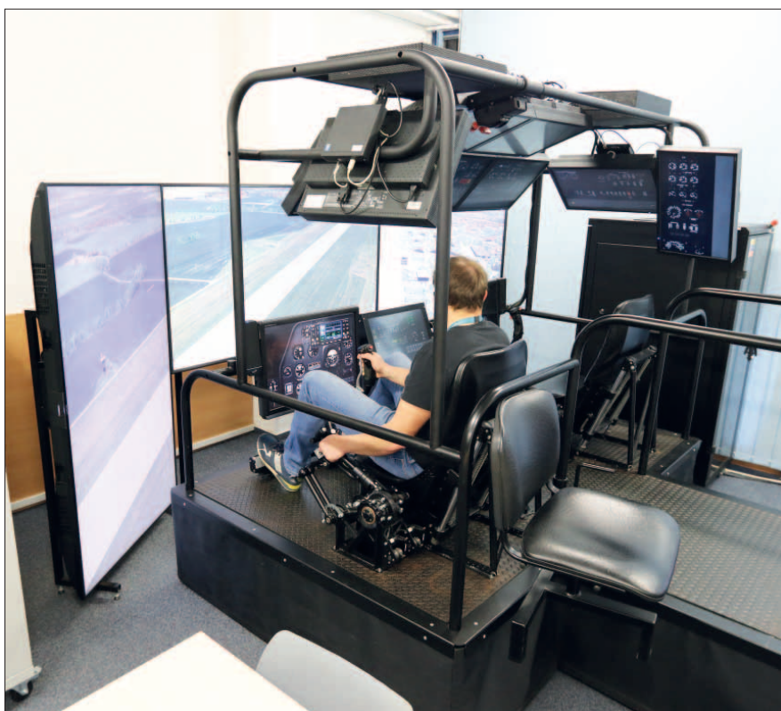
Trenažér CPT umožňující změnu konfigurace pro vrtulníky Mi-17 a Mi-171Š
