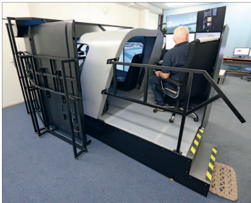
Celkový pohled na trenažer vrtulníku Enstrom 480B-G s kabinou a pracovištěm instruktora
