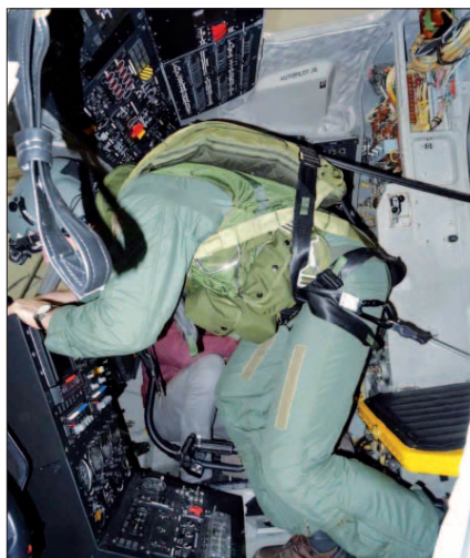
Nové pásy systému BSPT-2 pro palubního technika New seat belts of BSPT-2 system for the engineer
