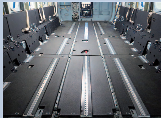
Pancéřování podlahy a boků nákladové kabiny Ballistic protection of the cargo cabin
