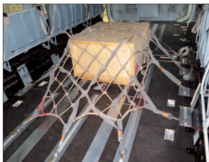
Nový systém pro uchycení nákladu v kabině New system for cargo securing in the cabin
