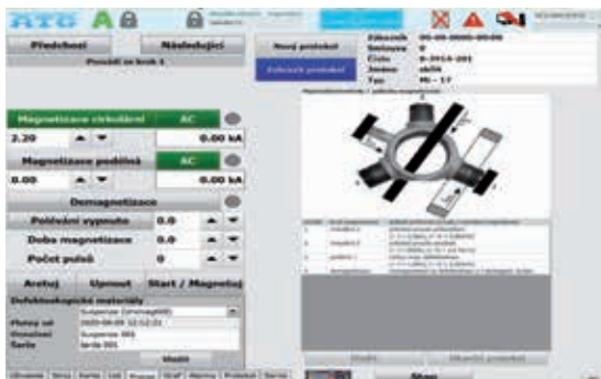
Unimag 600, detail obrazovky ovládání magnetizačního procesu a celkový pohled na pracoviště.
