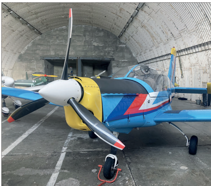
Z-142C AF pardubického Centra leteckého výcviku zkušebně osazený novou vrtulí Woodcomp KW 10
