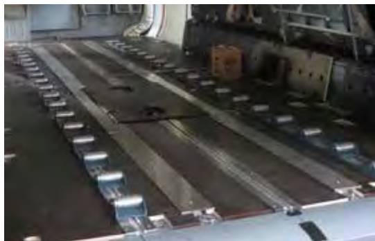
Instalovaný systém upínání nákladu s pancéřováním a válečkovou dráhou
