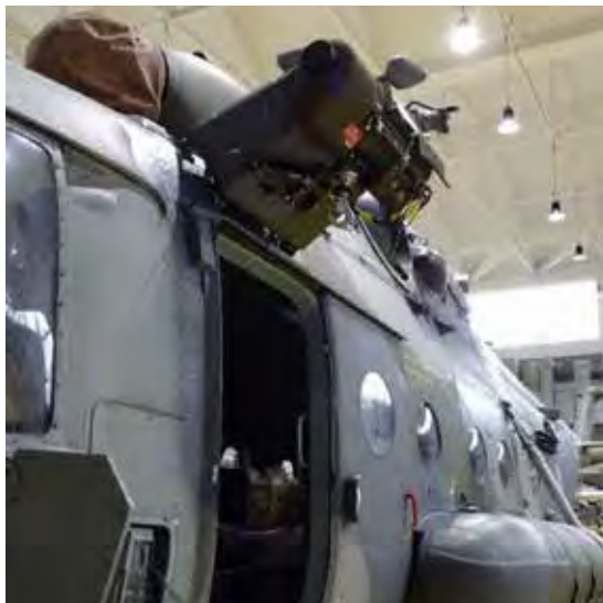
Jeřáb a stupačka
