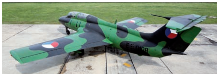
L-29 po renovaci. Viditelné jsou perforované brzdící štíty a pitot-statická trubice ve vřetení stabilizátoru
