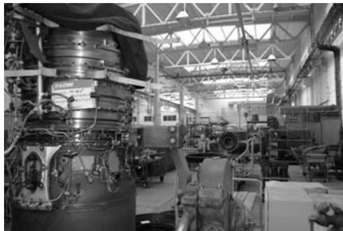
Montáž motoru AL-21F3 pro letadlo Su-22
