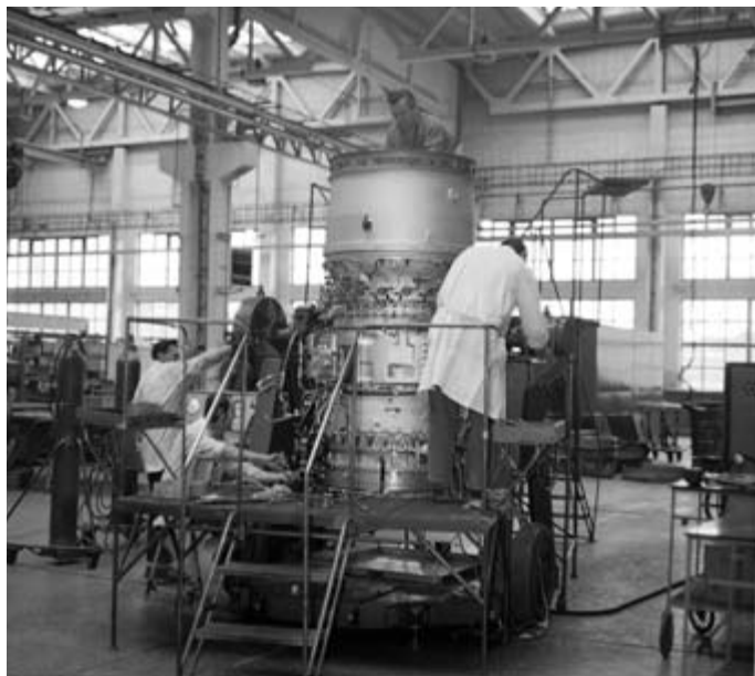
Montáž motoru R-95Š pro letadlo Su-25
