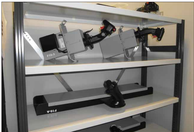
Velmi věrné a plně funkční repliky řídicích pák vyrábí společnost VR Group. Vlevo pro stroj F-16, vpravo pro L-39
