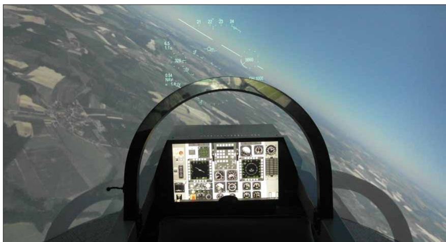
Simulátor konfigurovaný pro letoun L-159 ALCA s původním avionickým vybavením
