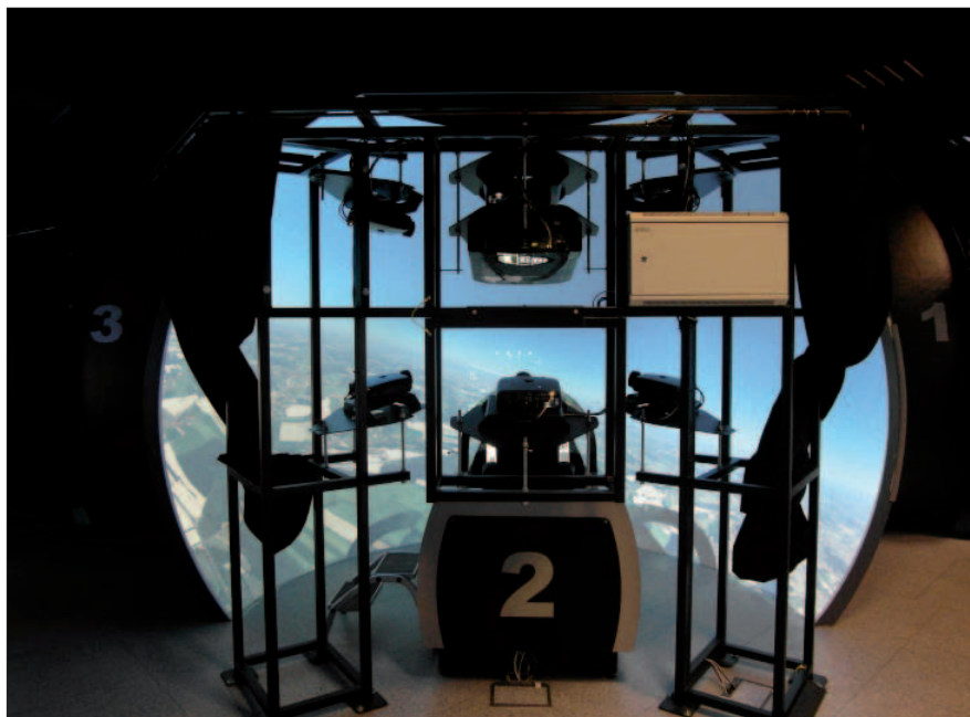
Jeden ze čtyř simulátorů se sférickým zobrazením. V titulu menší trenažer v konfiguraci F-16C
